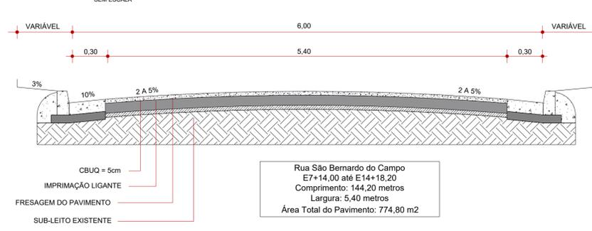
DETALHE 1 - SEÇÃO TÍPICA DO PAVIMENTO COM CAPEAMENTO ASFÁLTICO
