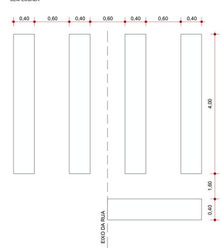
DETALHE 3 SARJETÃO EM CONCRETO L=0,90m
